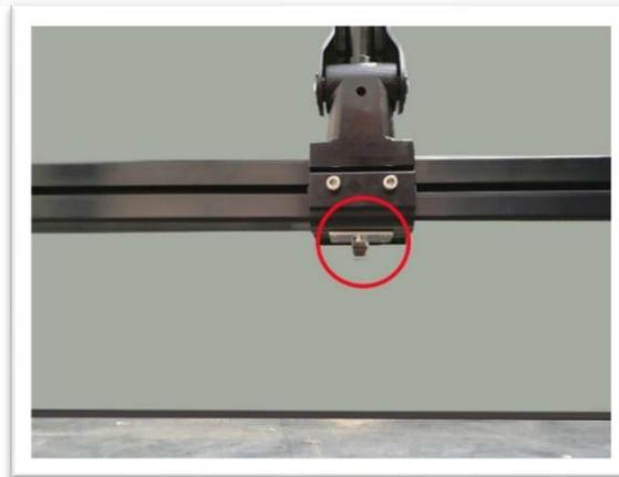
Draai alle bouten vast met het aanhaalmoment aangegeven in Fig.1 gebruik Loctite 243
